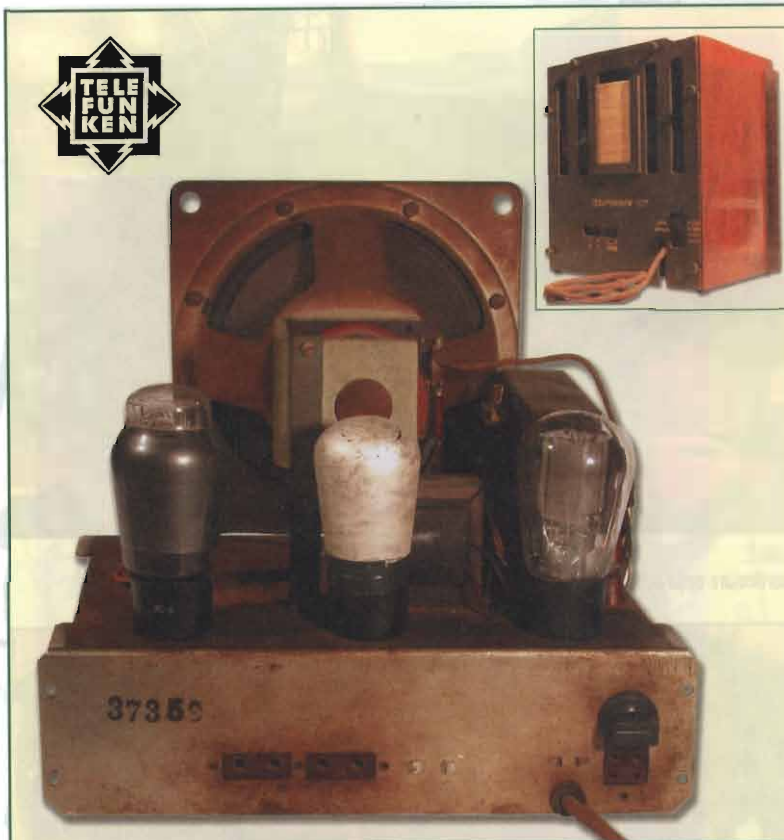
foto 1: disposizione dei componenti sopra il telaio
