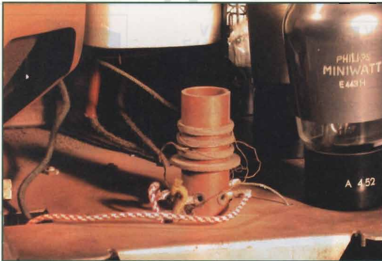
foto 2: particolare della bobina di entrata
