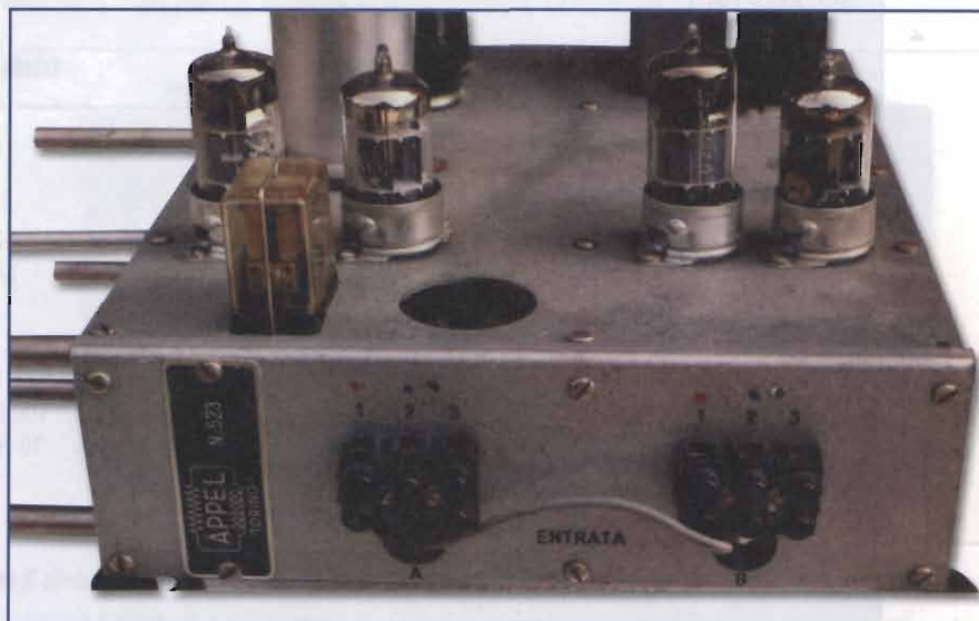
foto 6 Pre, si noti il relè a sinistra, azionato dal pulsante MONO / STEREO
