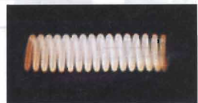
Proiezione del filamento di una lampada alogena
